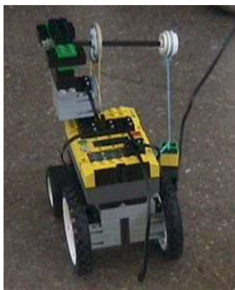
Rajah 11 : Set Lego Mindstrom RCX (Bers, et al. ,2002).
