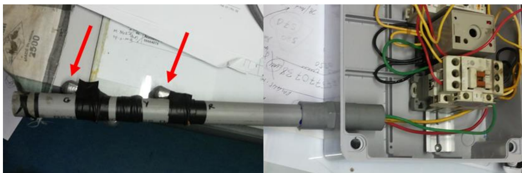
Gambarfoto 7: Menunjukkan FAS(D) menggunakan batu ladung sebagai suis pengesan
