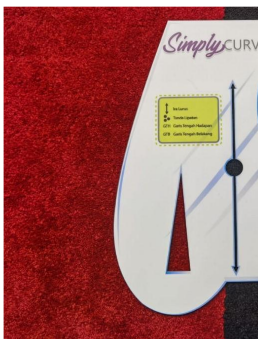
Rajah 6: Fungsi lengkung pada pembaris untuk membentuk pola lubang lengan, bentuk pinggang, punggung, leher, cawat seluar, kepala lengan.
